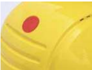
TESTER indicatore usura raggi U.V. Tester rosso: elmetto utilizzabile Tester bianco: sostituire l'elmetto
